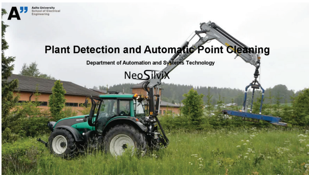
Kuva 3: Automaattisessa varhaisperkauksessa taimet havainnoidaan ja paikannetaan konenäöllä, visual servoing -puomin ohjauksessa. (Lähde: Aalto yliopisto)
