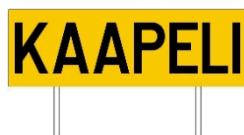
Kuva 36. Kaapeli- ja johtotaulu
